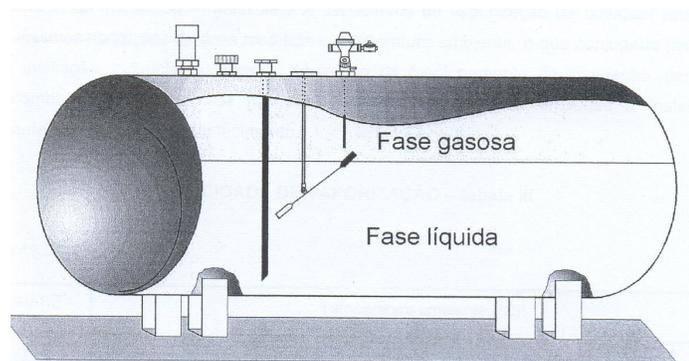
Figura 12 – vaporização do gás de um reservatório.
