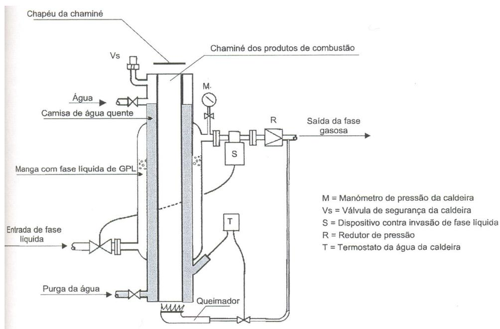
Figura 11 - Vaporização artificial.
