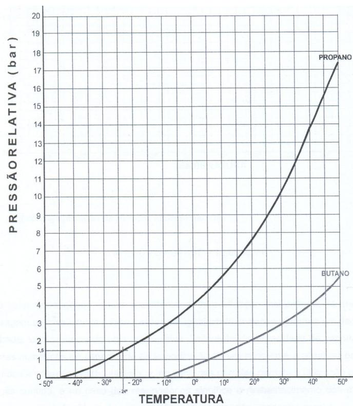
Figura 14 - Pressão de vaporização do Butano e Propano em função da temperatura.
