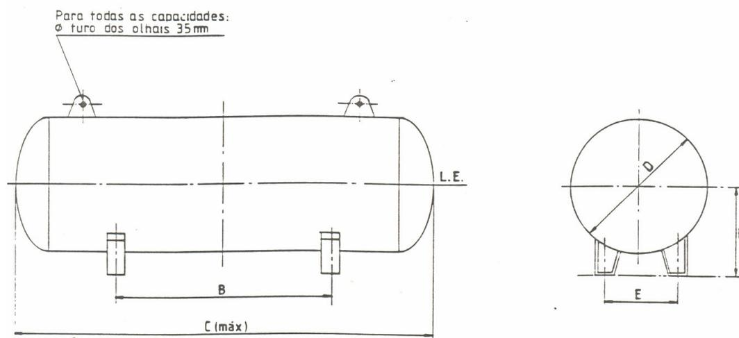
Figura 6 – Reservatório de superfície para GPL.
