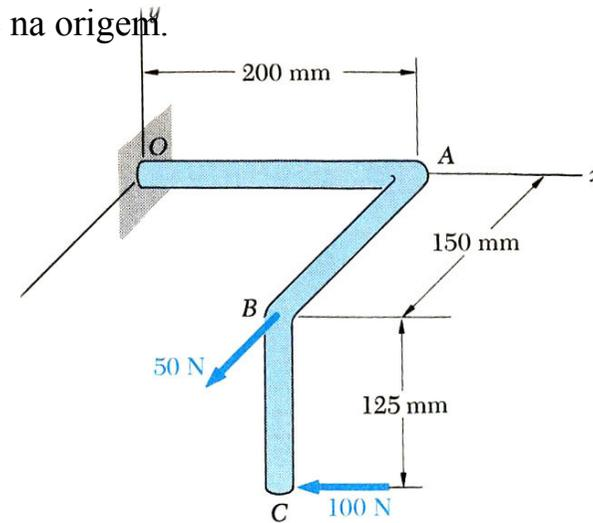
3.8- Para a viga apresentada, substitua as forças por um sistema força binário equivalente em A. b) um sistema força binário equivalente em B. c) uma única força resultante.
