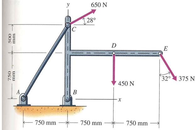
3.6- Substitua as três forças por um sistema força binário equivalente em A.
