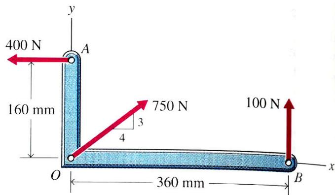
3.7- Substitua as três forças por um sistema força binário equivalente na origem.
