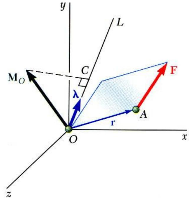
Significado físico: o momento  $\vec{M}_{ol}$  de  $\vec{F}$  em relação ao eixo OL mede a tendência da força  $\vec{F}$  produzir no corpo rígido um movimento de rotação em torno do eixo fixo OL.
