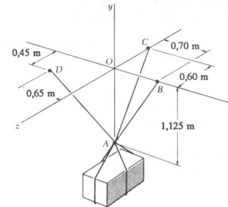
2.11- Uma caixa está suspensa por três cabos, como ilustrado. Determine o peso da caixa sabendo que a força de tracção no cabo AB é de 3kN.
