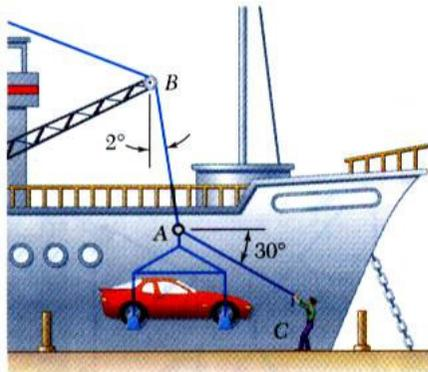
2.5-Determine a intensidade e direcção de P de modo que a resultante de P e da força de 900 N seja uma força vertical de 2700 N direccionada para baixo.
