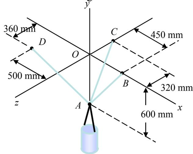
2.9- A força instalada no cabo AC é de 28kN, determine as forças instaladas nos cabos AB e AD de forma a que a força resultante das três forças aplicadas em A seja vertical. Determine a força resultante.
