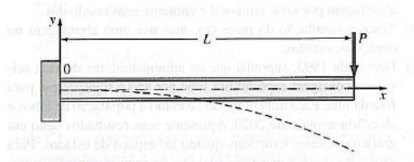
A equação diferencial básica de uma curva elástica para a viga em balanço acima ilustrada é dada pela expressão
