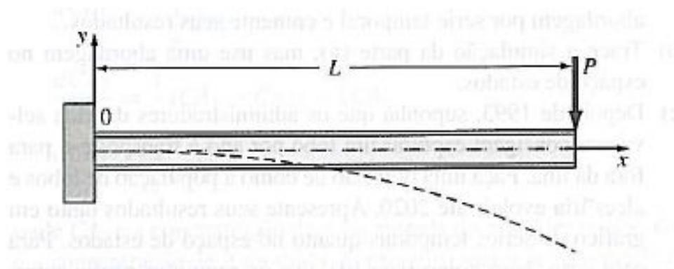
A equação diferencial básica de uma curva elástica para a viga em balanço acima ilustrada é dada pela expressão
