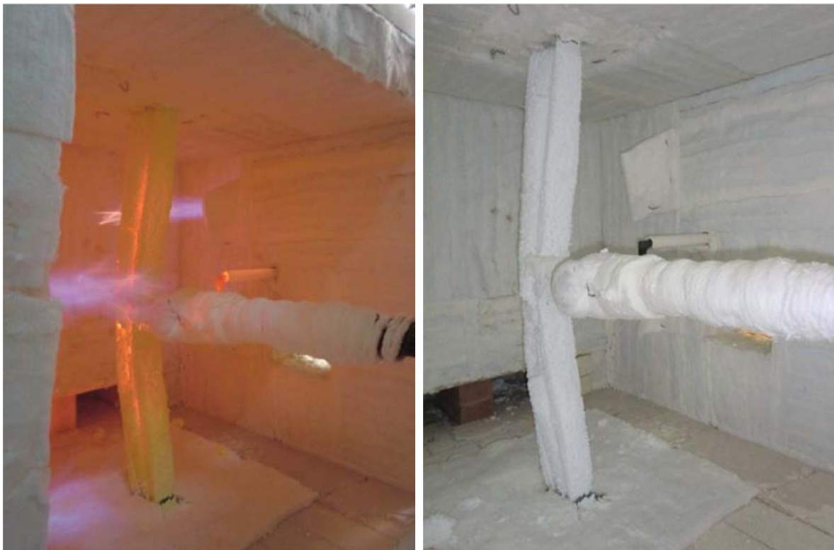
Figura 52 – Deformada no ensaio I7.
