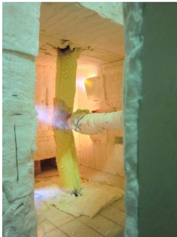
Figura 85 – Deformada sofrida no ensaio C11.
