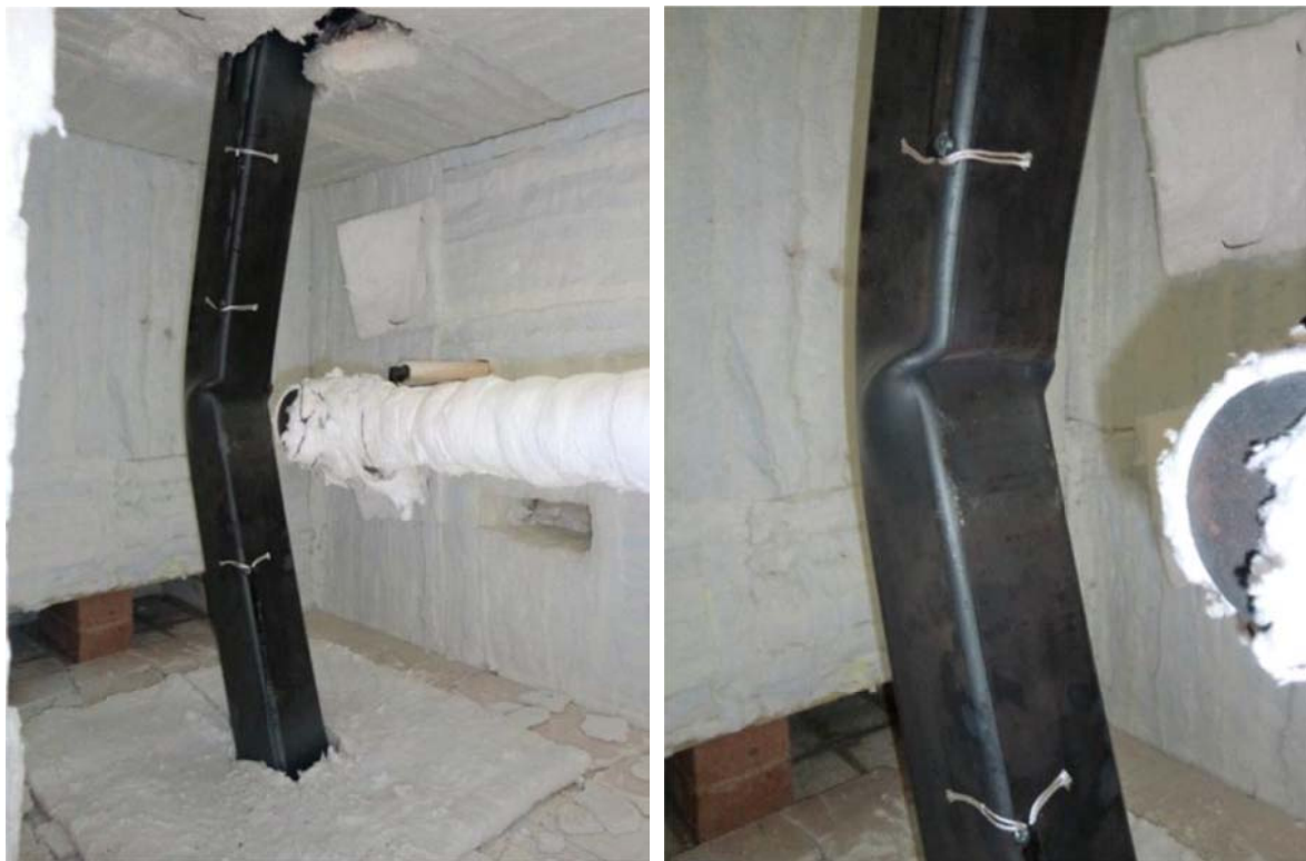
Figura 39 - Fotos da deformada sofrida no ensaio S4
