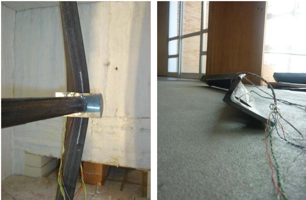
Figura 34 - Fotos da deformação sofrida no ensaio L1.
