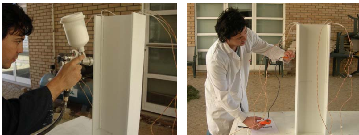
Figura 3.16 – Aplicação do intumescente e controlo de espessura.
