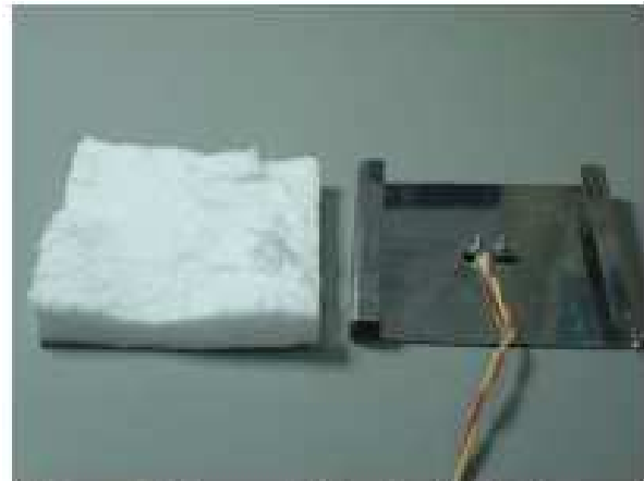
b) Termopar de placa, constituído por fio tipo K e chapa em aço inox A304.
