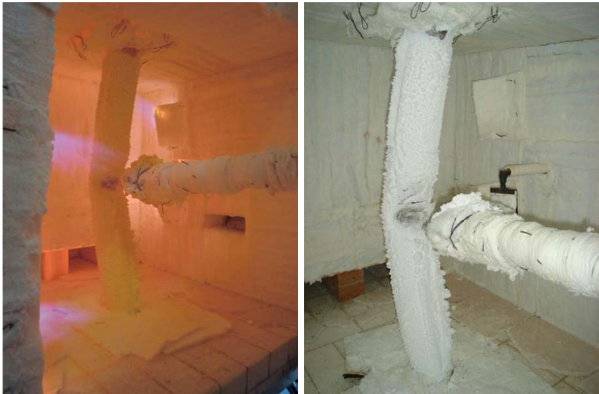
Figura 78 – Deformada sofrida no ensaio C7.
