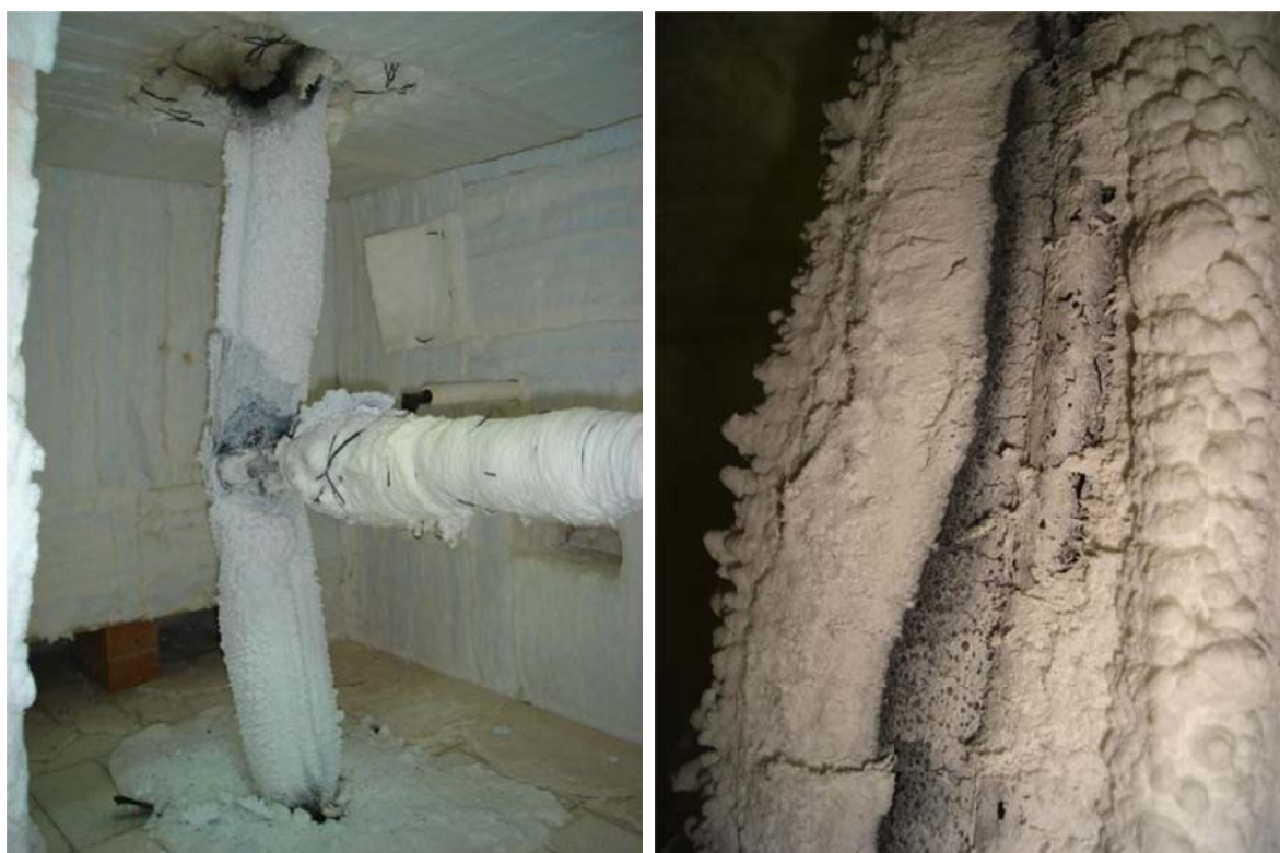
Figura 82 – Deformada sofrida e retracção da camada intumescente no ensaio C9.
