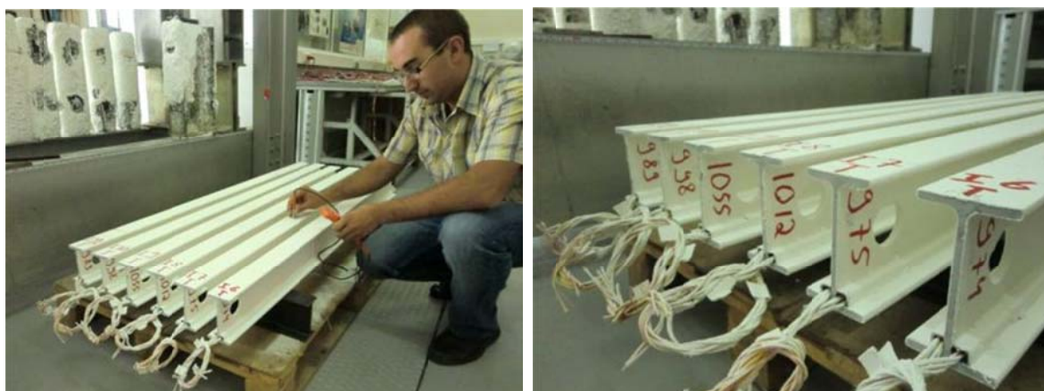
Figura 20 – Observação do controlo dimensional da espessura de tinta nos elementos.
