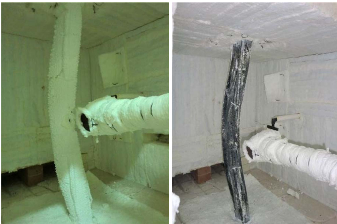
Figura 96 – Deformada sofrida e camada de intumescência no ensaio L9.
