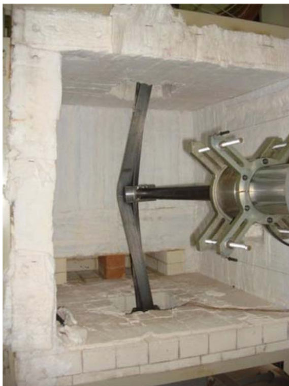
Figura 28 - Fotos da deformação sofrida no ensaio I1.
