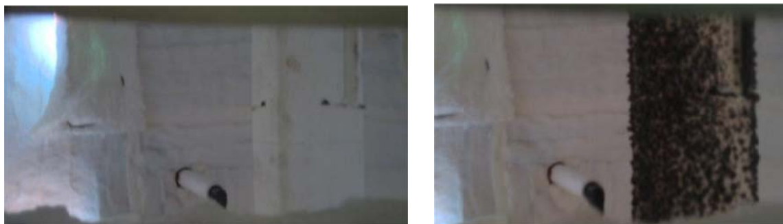
Figura 3 – À esquerda um elemento pintado quando o fogo se inicia, à direita quando a tinta inicia o seu processo de intumescência.
