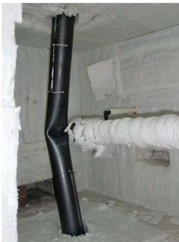
Figura 42 – Foto da deformada sofrida no ensaio C5.
