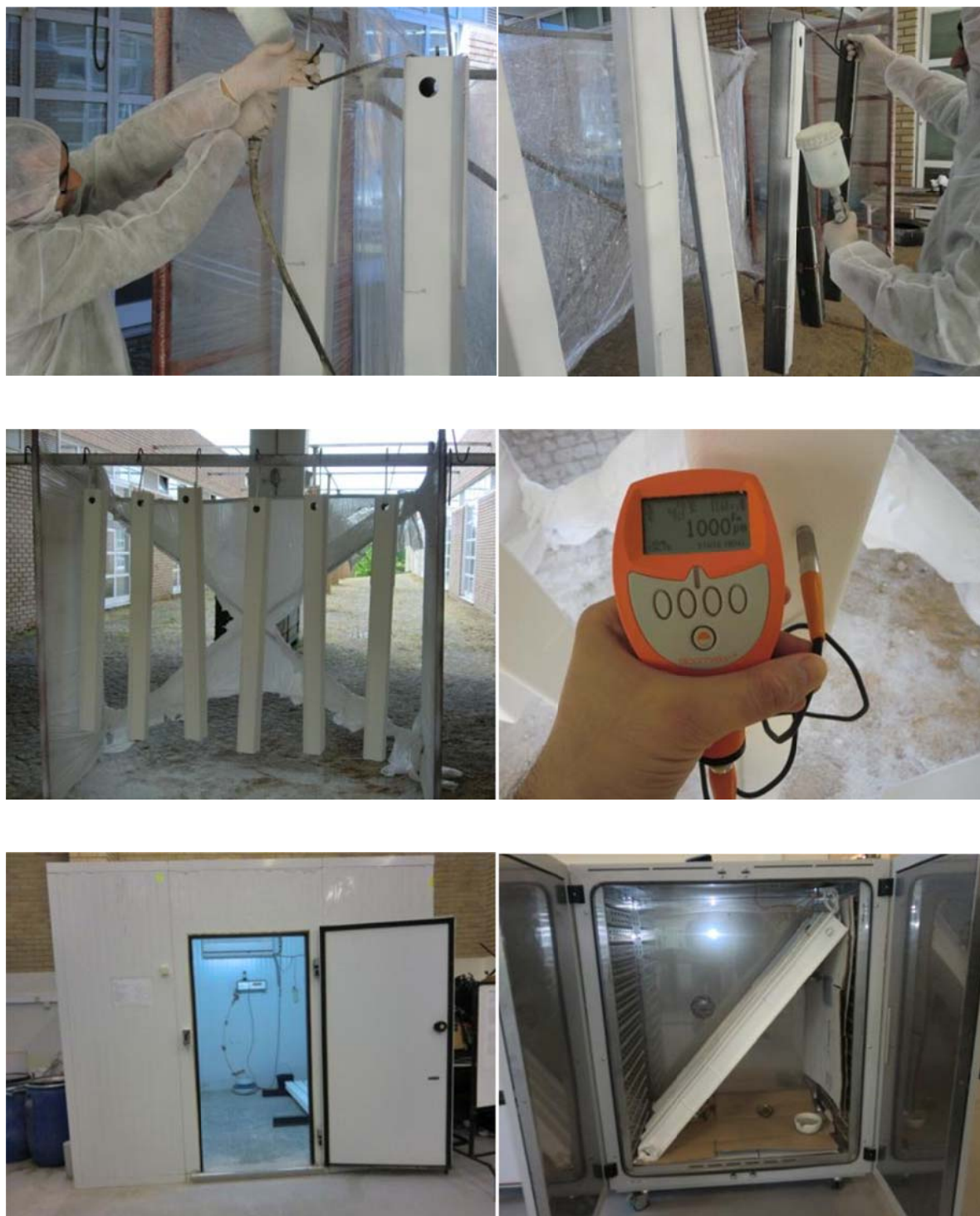
Figura 18 – Fases de pintura dos elementos (pintura, controlo dimensional e acondicionamento).
