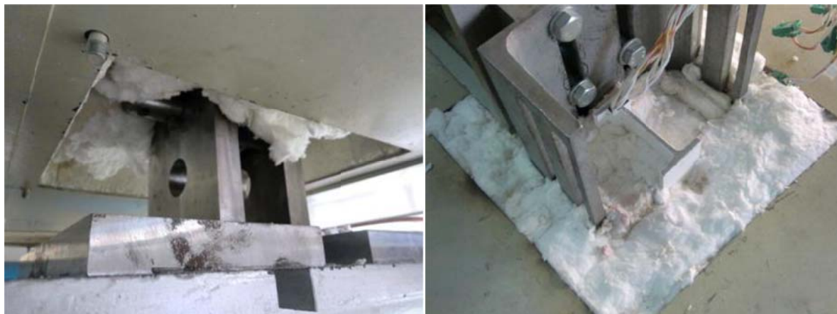
Figura 22 – Demonstração do isolamento nos apoios das extremidades.
