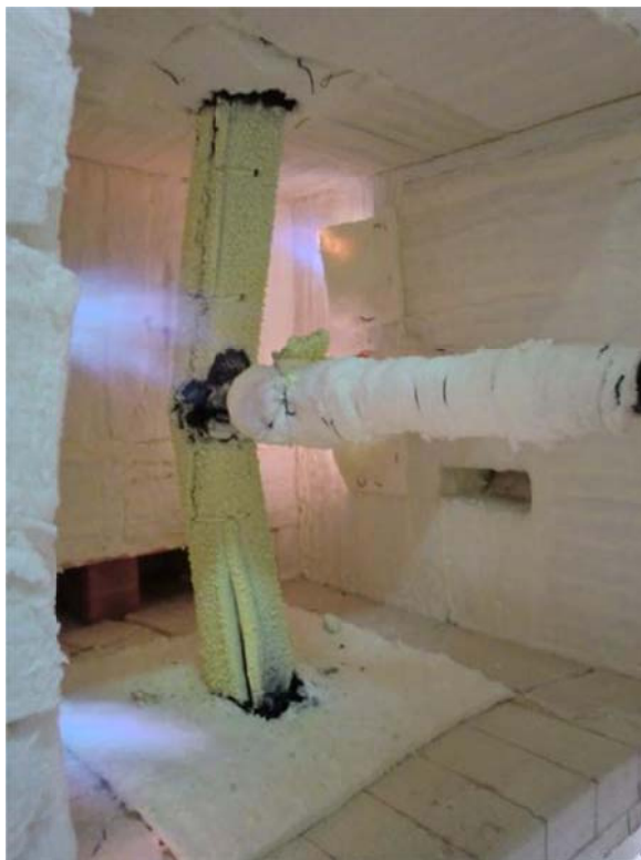
Figura 68 – Deformada sofrida no ensaio S10.
