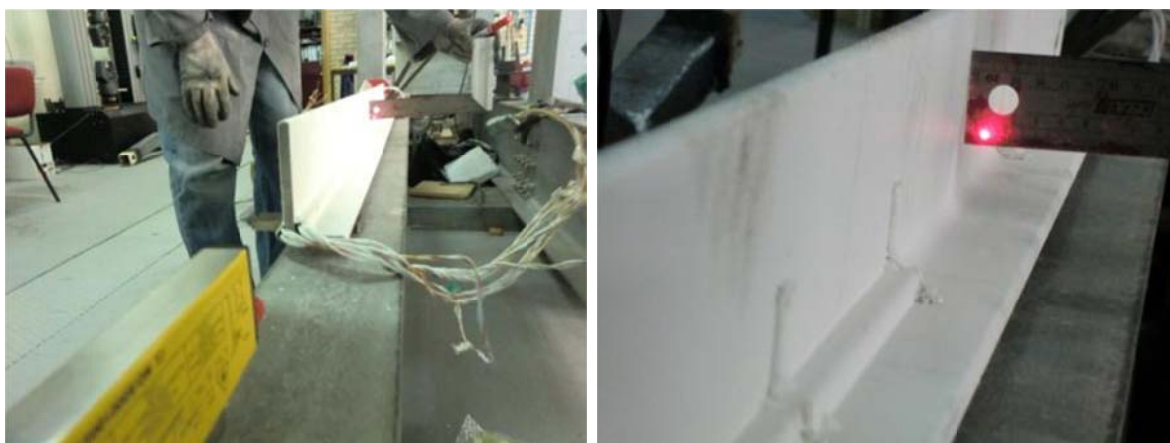
Figura 21 – Leitura da imperfeição geométrica de cada elemento.
