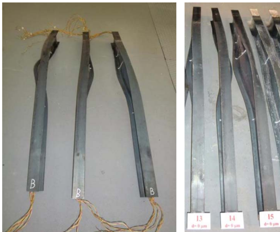
Figura 105 - Deformação sofrida nos elementos IPE ao fogo, sem protecção.
