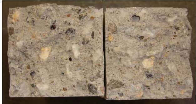
d) Material depois de ensaio destrutivo.
