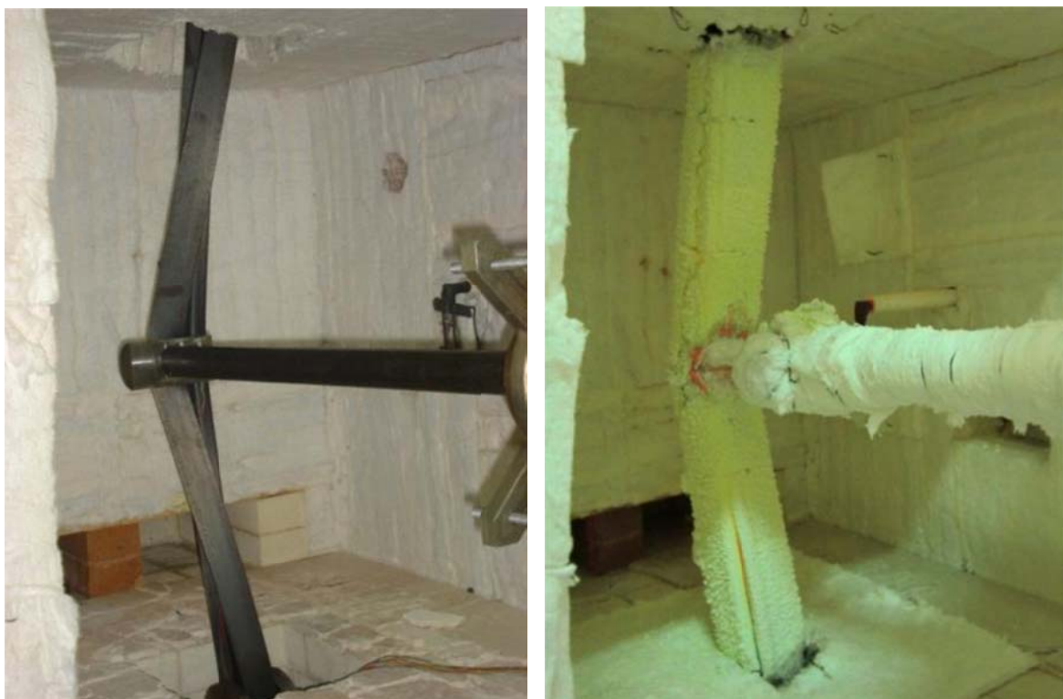
Figura 27 – Estado limite último do ensaio I3 e do ensaio S6.
