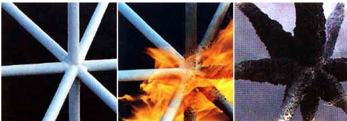
Figura 3.17 - Reacção da tinta intumescente.
