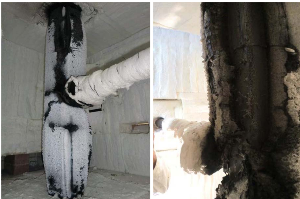
Figura 74 – Retracção da intumescência sofrida no ensaio S13.
