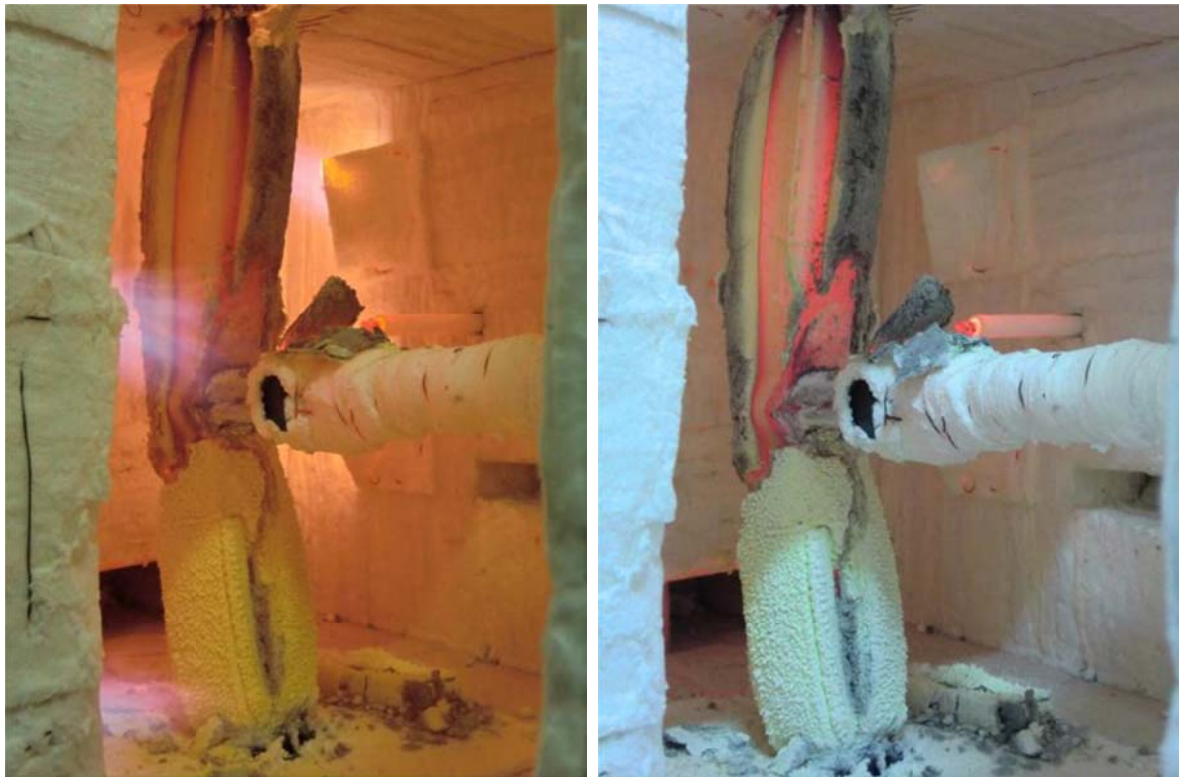
Figura 72 – Deformada sofrida no ensaio S12.
