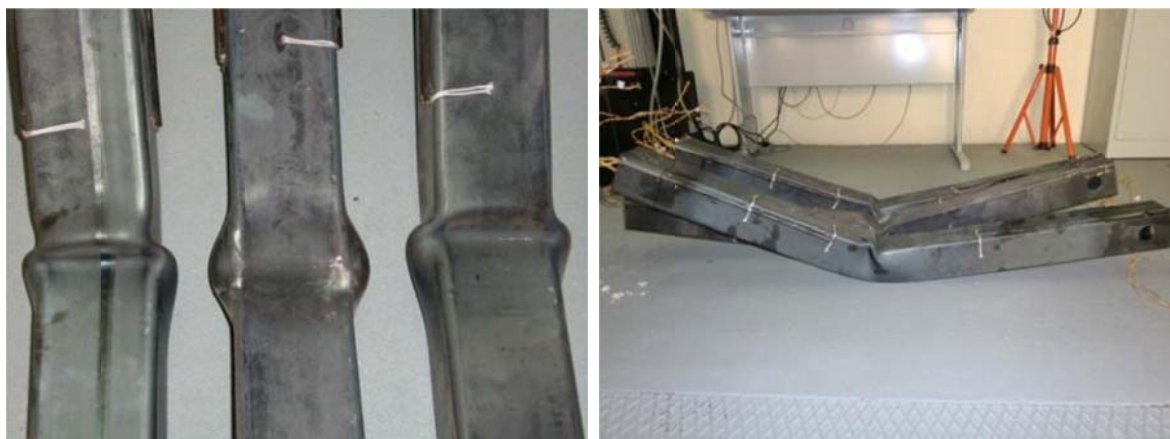
Figura 106 - Deformação sofrida nos elementos SHS ao fogo, sem protecção.
