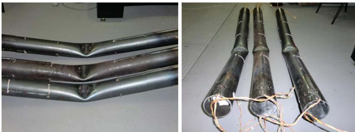
Figura 107 - Deformação sofrida nos elementos CHS ao fogo, sem protecção.
