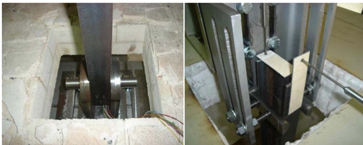
Figura 5 - Apoios experimentais. (duplo à esquerda, simples à direita).
