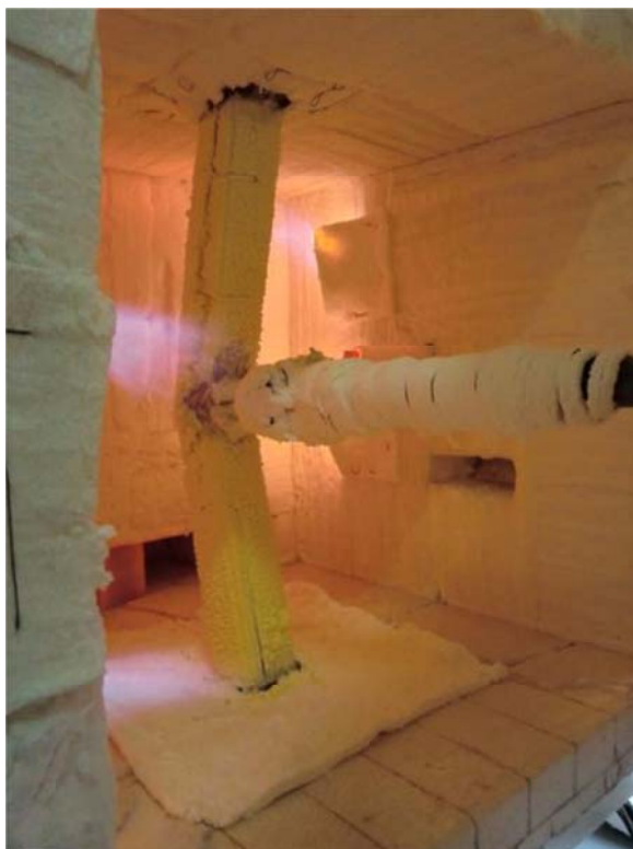
Figura 67 – Deformada sofrida no ensaio S9.
