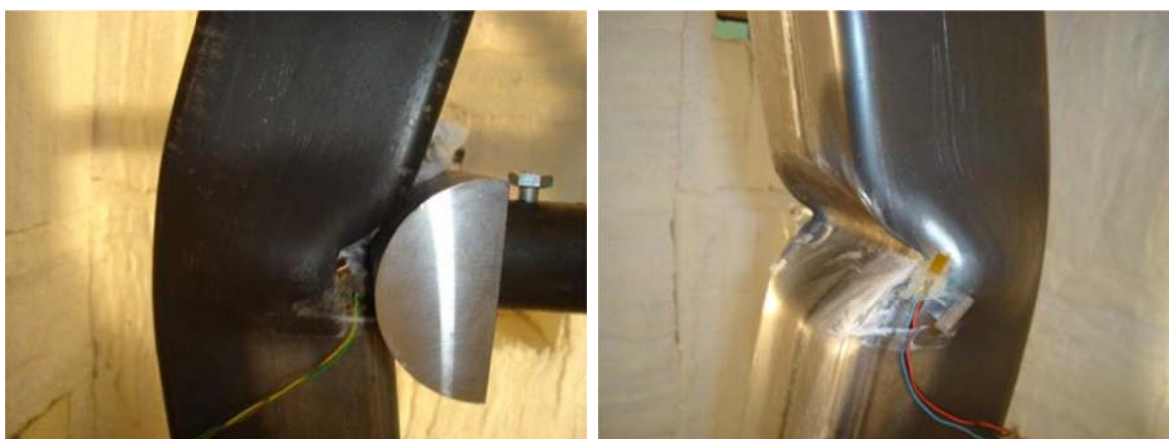
Figura 30 - Fotos da deformação sofrida no ensaio S1.
