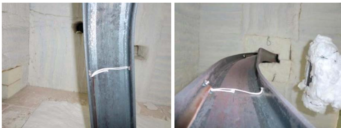
Figura 37 - Fotos da deformada sofrida no ensaio I4.
