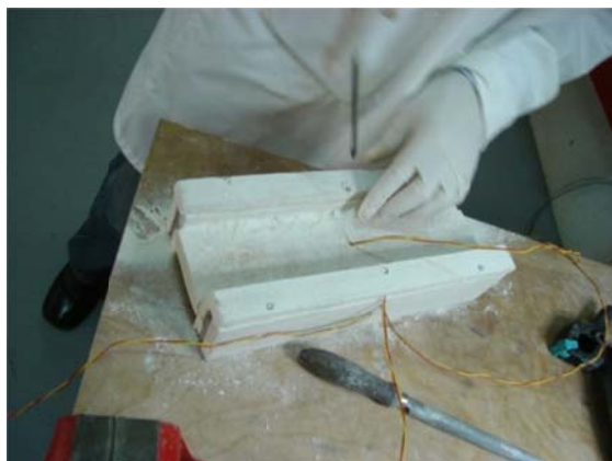
Figura 5.22 – Isolamento do elemento estrutural em silicato de cálcio.
