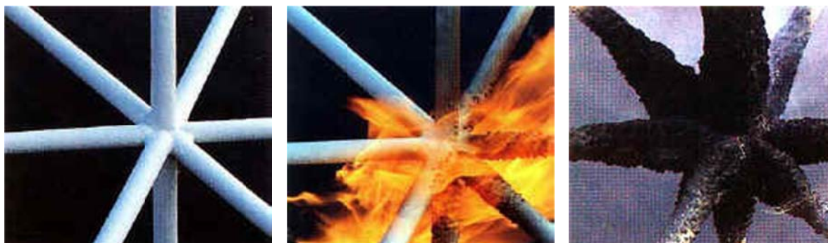
Figura 2.10 - Reacção da tinta intumescente.
