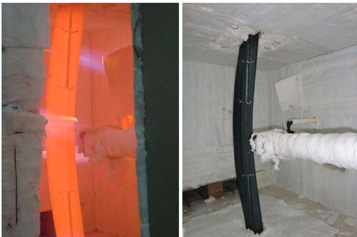
Figura 44 - Fotos da deformada sofrida no ensaio L3.
