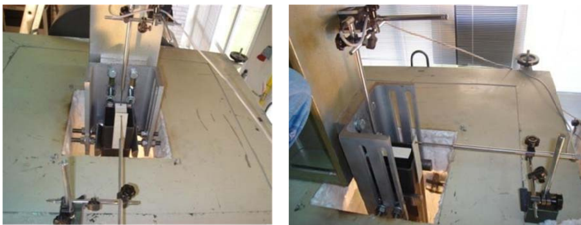
Figura 7 - Posição dos LVDT's no elemento.
