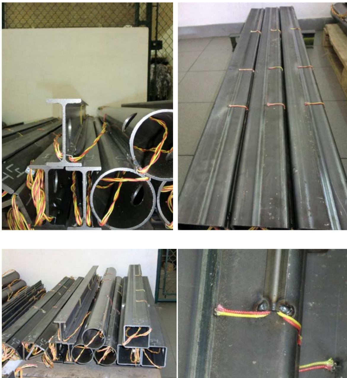
Figura 17 – Elementos com sensores de temperaturas (termopares) instalados e protegidos.
