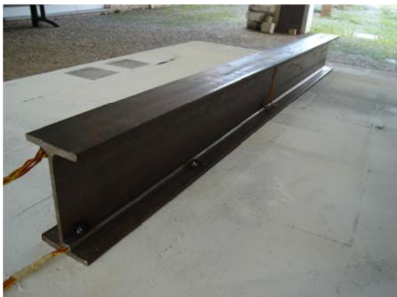
Figura 5.30 - Posição dos termopares para leitura das temperaturas no IPE100
