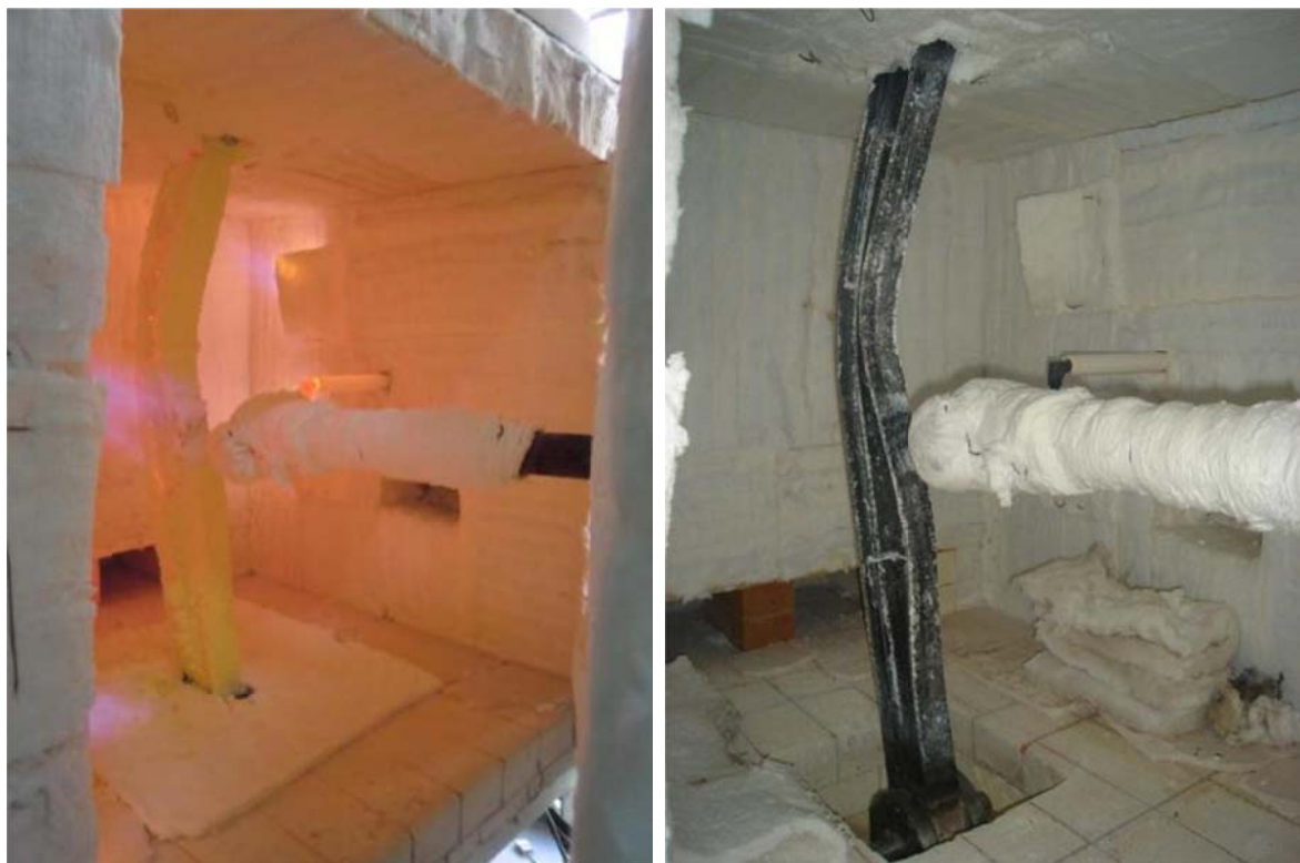
Figura 54 – Deformação sofrida no ensaio I9.
