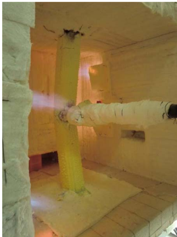
Figura 64 – Deformada sofrida no ensaio S7.
