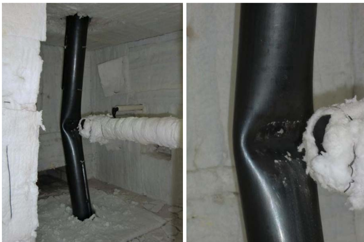
Figura 41 - Fotos da deformada sofrida no ensaio C4
