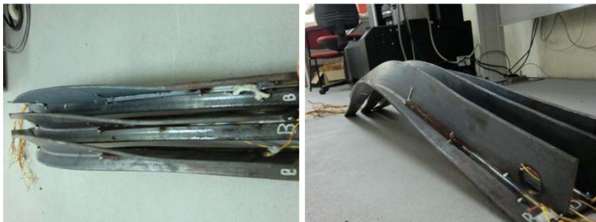
Figura 108 - Deformação sofrida nos elementos LNP ao fogo, sem protecção.
