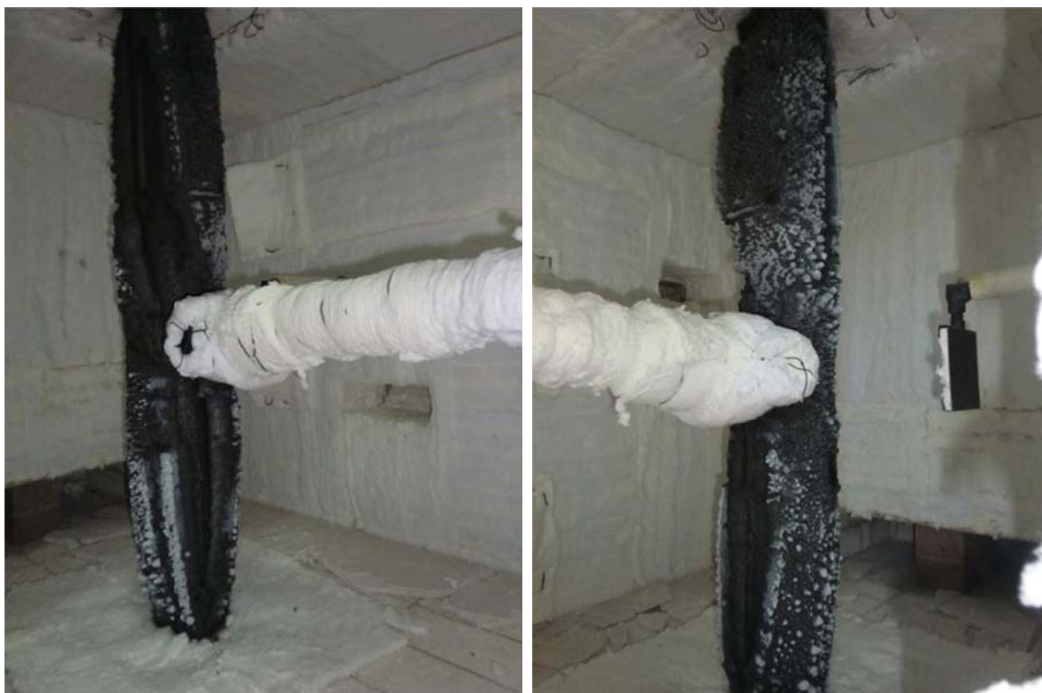
Figura 80 – Retracção da intumescência sofrida no ensaio C8.
