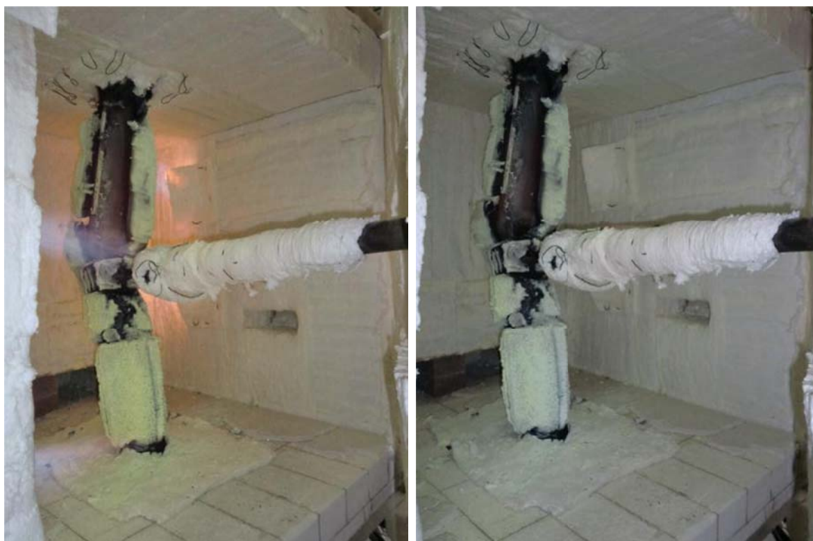
Figura 87 – Deformada sofrida e retracção da camada intumescente no ensaio C12.
