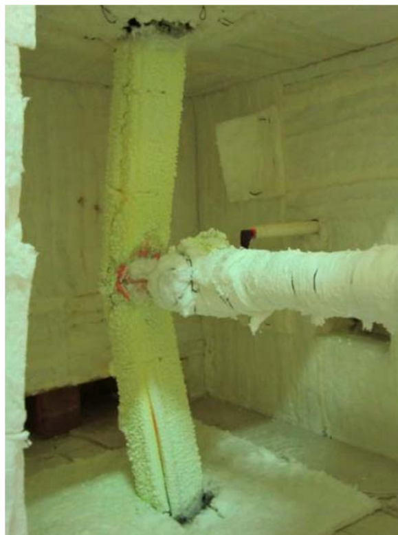
Figura 65 – Deformada sofrida no ensaio S8.
