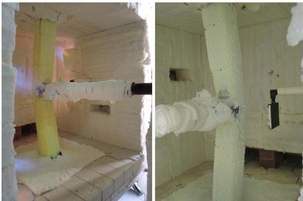
Figura 62 – Deformada sofrida no ensaio S6.
