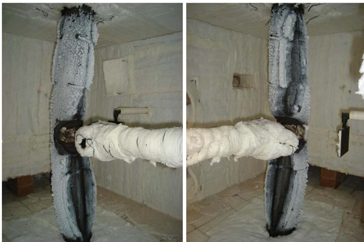
Figura 83 – Deformada sofrida e retracção da camada intumescente no ensaio C10.
