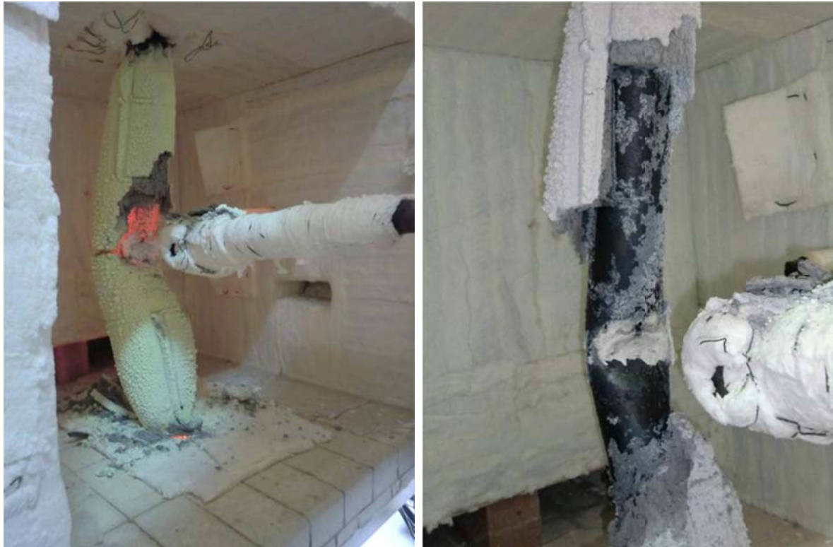
Figura 89 – Deformada sofrida e retracção da camada intumescente no ensaio C13.
