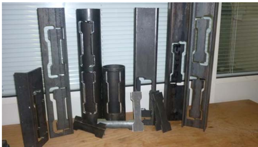
Figura 1 – Provetes maquinados para ensaios à tracção.
