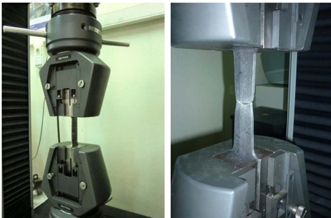
Figura 2 – Ensaios realizados de teste à tracção dos provetes.
