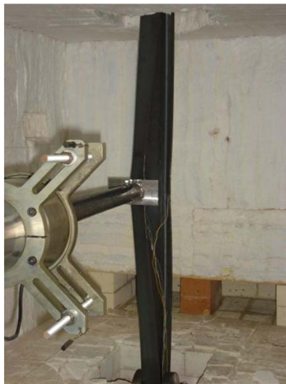
Figura 28 - Fotos da deformação sofrida no ensaio I1.
