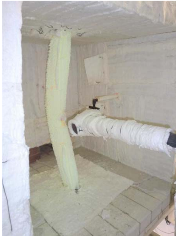
Figura 94 – Deformada sofrida no ensaio L8.
