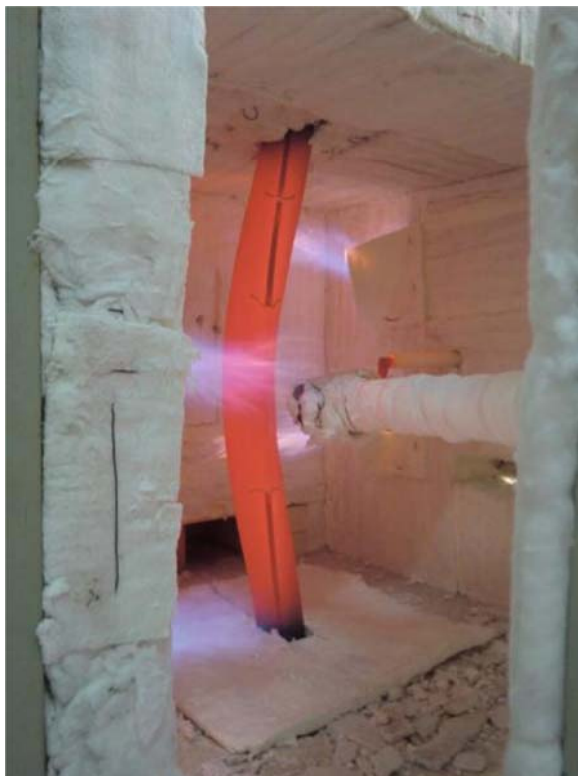
Figura 46 – Foto da deformada sofrida no ensaio L5.
