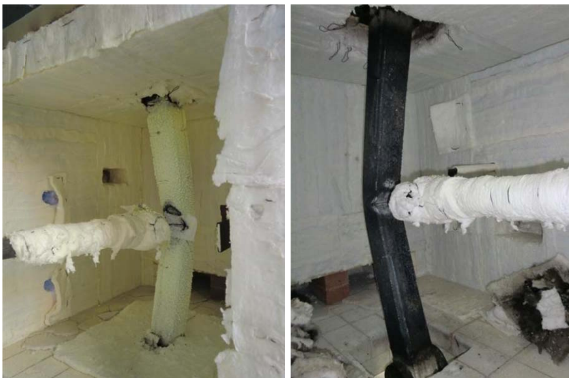
Figura 70 – Deformada sofrida no ensaio S11.
