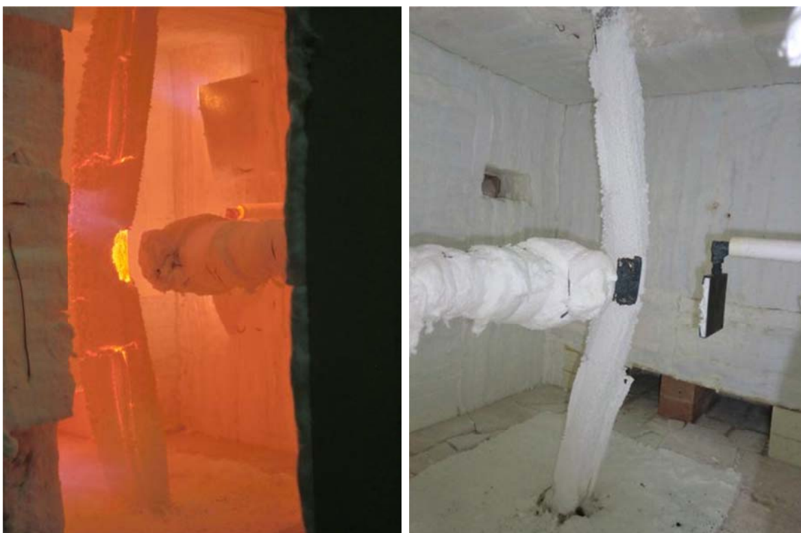
Figura 91 – Deformada sofrida no ensaio L6.
