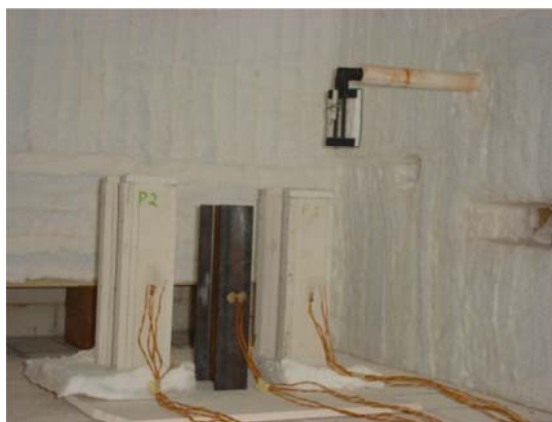
Figura 5.23 – Visualização dos elementos estruturais com e sem protecção no interior do forno.
