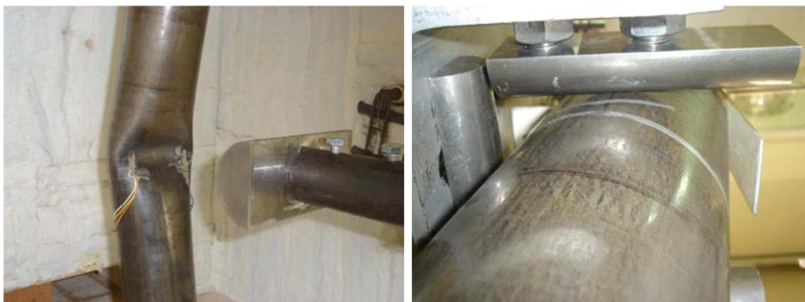
Figura 32 - Fotos da deformação sofrida no ensaio C1.
