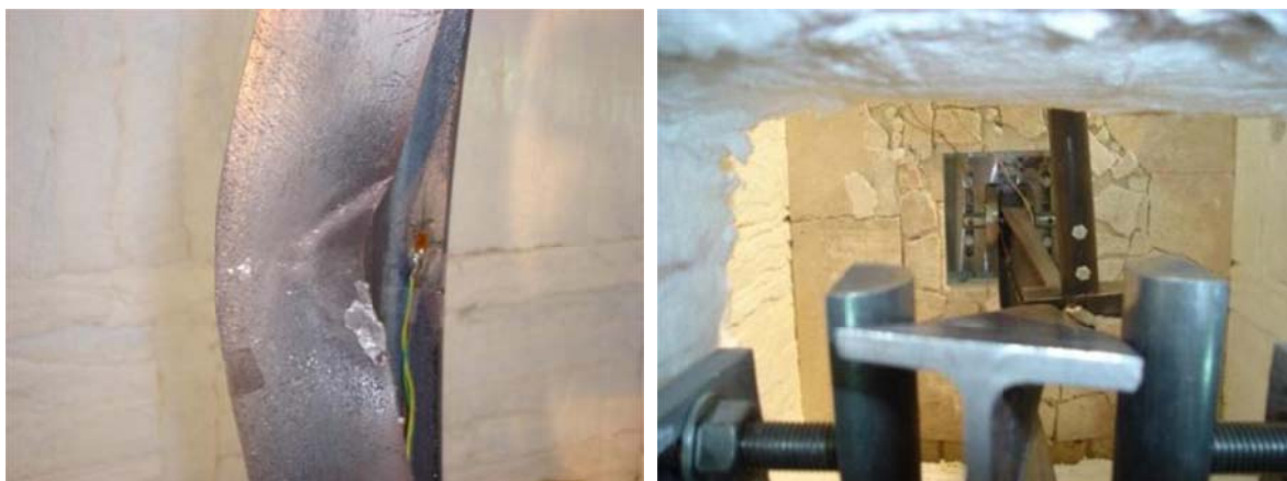
Figura 29 - Fotos da deformação sofrida no ensaio I2.
