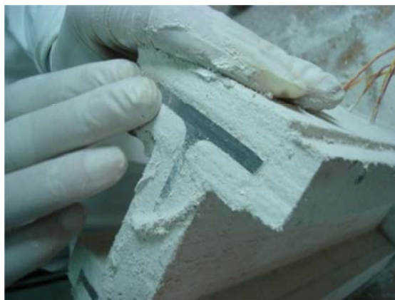
Figura 5.22 – Isolamento do elemento estrutural em silicato de cálcio.
