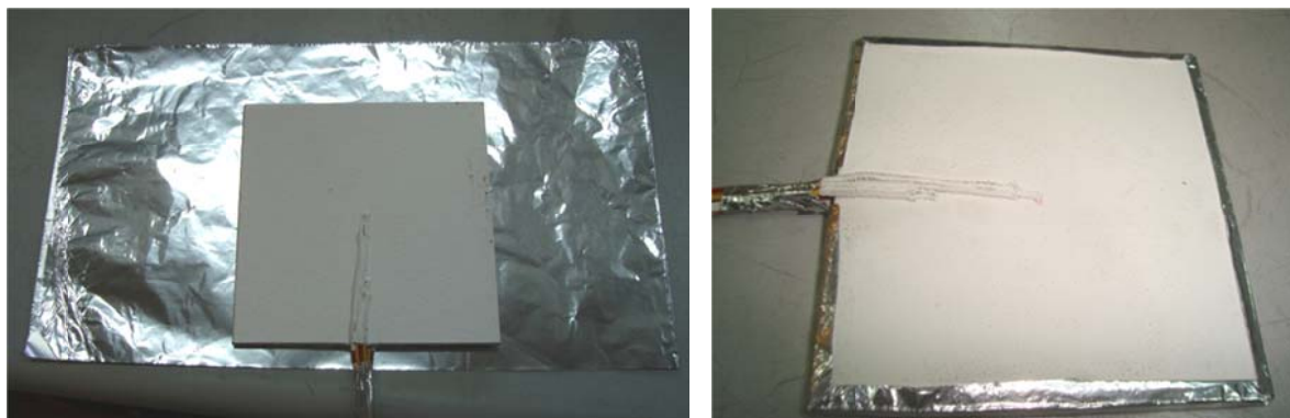
Figura 4.6 – Envolvimento do provete com folha de alumínio.
