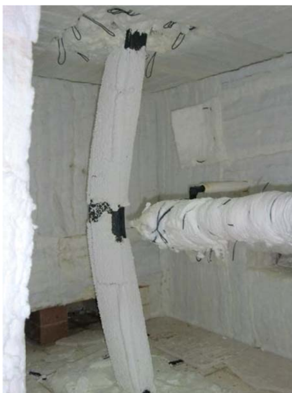
Figura 92 – Deformada sofrida no ensaio L7.
