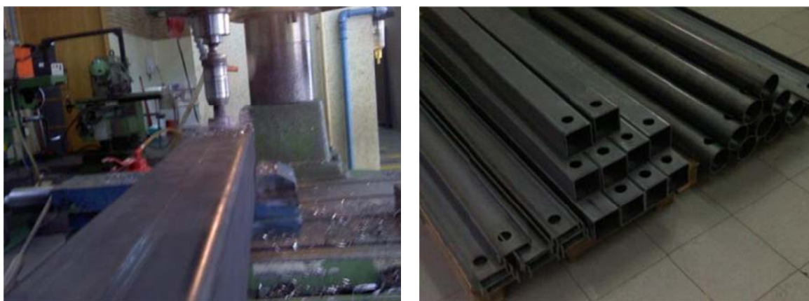
Figura 10 - Corte e furação dos elementos.
