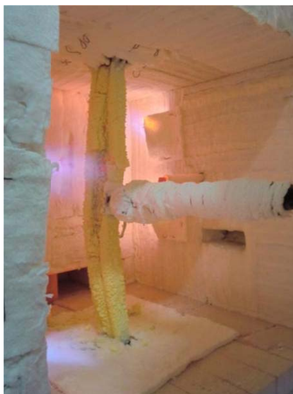
Figura 56 – Deformação sofrida no ensaio I11.
