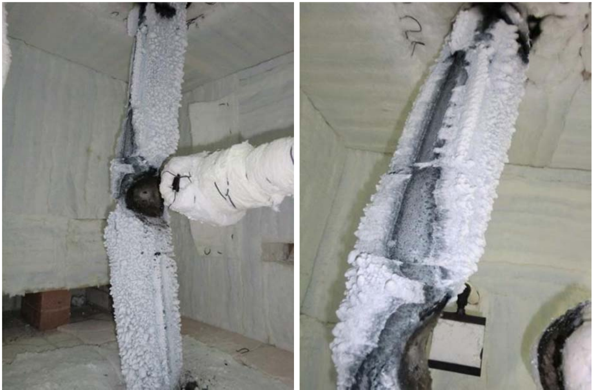
Figura 76 – Deformada sofrida e a retracção da camada intumescente no ensaio C6.
