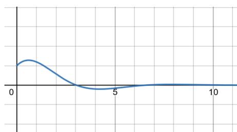
Figura 27: Resposta do sistema massa-mola-amortecedor.
