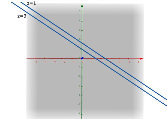
Figura 6: Curvas de nível do plano  $2x + 3y + z = 6$ .
