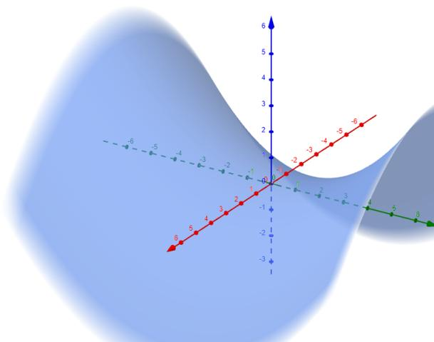
Figura 7: Vista do parabolóide hiperbólico.
