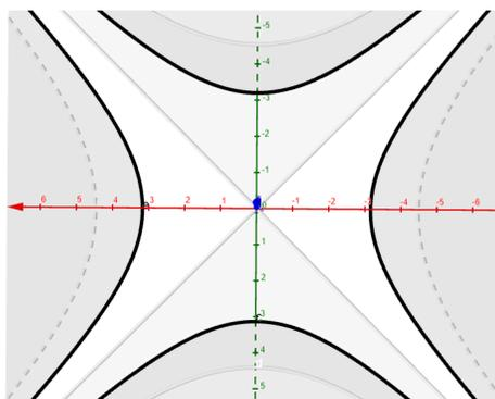
Figura 12: Curvas de nível do parabolóide hiperbólico.
